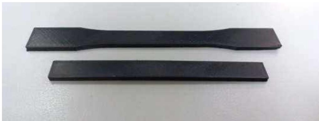
**Figura 5.** Probetas en ABS impresas en 3D. Archivo personal.
